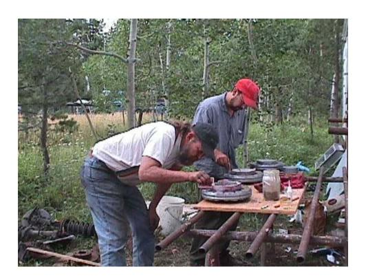
Retiramos el rotor frontal. No debe ser tan difícil, pues no tiene imanes. Una vez que los tenga quizás resulte conveniente usar un separador. Los imanes deben ser colocados empleando la misma técnica que empleamos para colocarlos en el rotor trasero.
