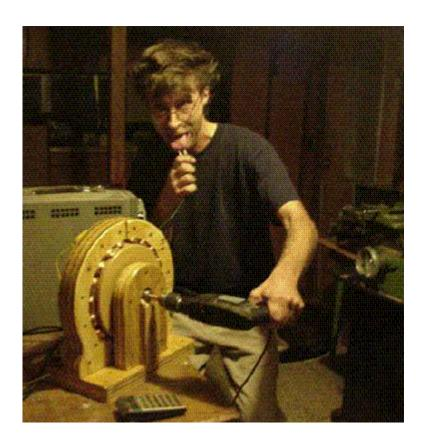
El alternador no cabe en nuestro torno, de manera que las pruebas fueron bastante limitadas. Tuvimos que usar un taladro que tiene un mandril de ½". Leyendo la frecuencia podemos medir la velocidad de giro. Cuando las dos mitades del estator fueron conectadas en serie obtuvimos 12 voltios a 120 RPM y a 300 RPM generamos 6 amperios a la batería.
