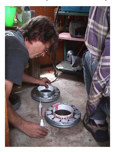
Una vez colocados los imanes colocamos una tira de cinta alrededor de los perímetros del disco de manera de rellenar los espacios entre los imanes con resina sin que esta ni se desborde ni los cubra.
