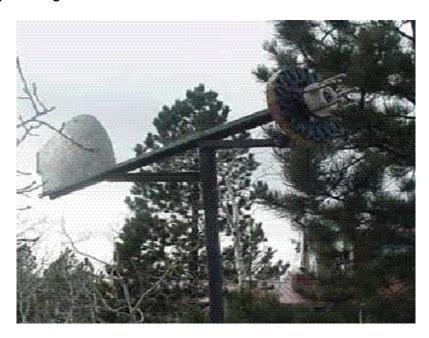
El inducido del alternador (El disco del freno) puede ser retirado quitando una cupilla y una tuerca.
