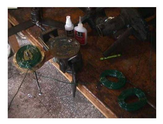
La fotografía de arriba nos muestra una bobina y los frascos de cemento y su catalizador instantáneo. Al terminar las nueve bobinas estamos listos para armar el estator, al que hay que fabricarle un molde.
