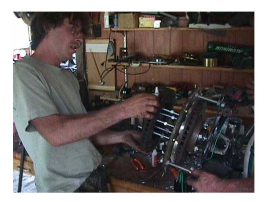
Una vez que las barras han quedado ajustadas podemos determinar dónde colocaremos las ruecas de manera que rotor apenas llegue al estator. Las tuercas tienen un espesor de ½" y usaremos otra de contratruerca. Las medidas deben ser muy exactas ya que no queremos que el rotor nos quede oscilando. La tuerca impedirá que al colocar el rotor final la atracción entre ambos sea tal que represente peligro a los dedos de sus instaladores.
