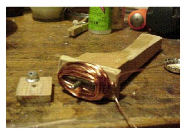
Para colocar las bobinas en su sitio, marque el arco que deben ocupar en el estator. Puede también colocar el rotor cuidadosamente sobre el estator con las bobinas y llevar cada una de ellas debajo de un imán. Este es un trabajo que requiere cuidado y precisión. Evite crear circuitos.
