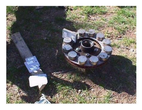
Los imanes se colocan sobre el disco del freno alternado sus polos. Primeramente los colocamos distanciados a ojo. Luego usamos cuñas delgadas (Barajas) hasta que queden perfectamente espaciados. En nuestro caso la distancia entre los imanes resultó ser ½ pulgada (O exactamente 49 barajas).
