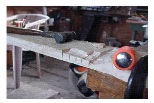
Haga algunos cortes con serrucho en la madera a algo menos de la profundidad que se requiere y empleando un formón la madera se separará fácilmente. Para terminar el trabajo bastarán una escofina y papel de lija. Con dos agujeros en el centro fijaremos este rotor a su sitio.
