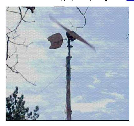
A seguidas describimos otro generador hecho en casa. En este usamos el puente delantero, base de la rueda, municioneras y disco del freno de un Volvo 240. Este diseño es adaptable a muchas otras unidades.
