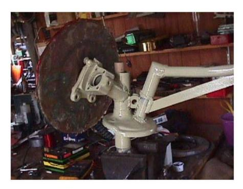
La foto anterior muestra el chasis con su veleta. La pintura empleada se basa en resina epóxica para evitar la oxidación de los elementos.
