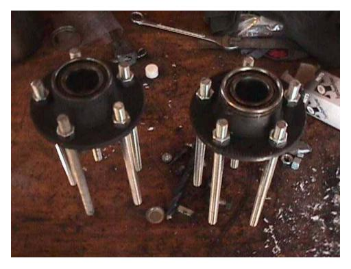
Retirados los tornillos los reemplazamos con barra de 10" de 1/2"-13. Estas barras se fijarán con tuercas a ambos lados de la base de la rueda. Es conveniente usar
