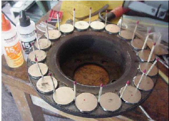
Cuando la resina sobre las bobinas haya fraguado, deshaga el conjunto y cubra toda la pieza con resina para protegerla de los elementos. Trate de hacer un buen trabajo, pues no queremos bajar este estator para cambiarlo por otro porque el agua de lluvia lo pudrió.
