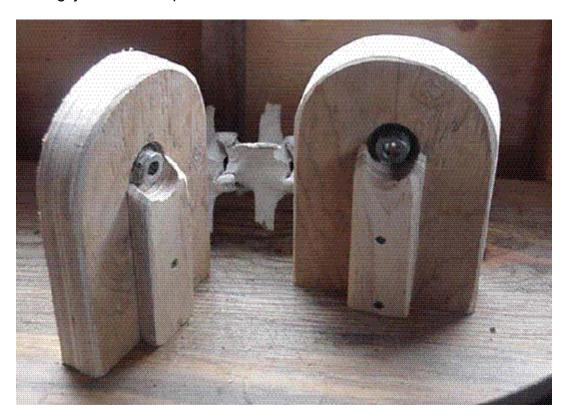
Las municioneras tiene un diámetro al eje de ½" y su diámetro externo es de 1.6". Como los agujeros en la madera sólo son de 1 ½" su ajuste es apretado. Se deberá usar una prensa para insertarlas debidamente recubiertas con resina epóxica. Debe tener cuidado con este paso para que las municioneras queden a plomo y por tanto el eje quede horizontal.
