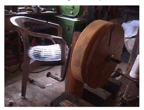
La fotografía anterior muestra nuestra máquina de fabricar bobinas.
