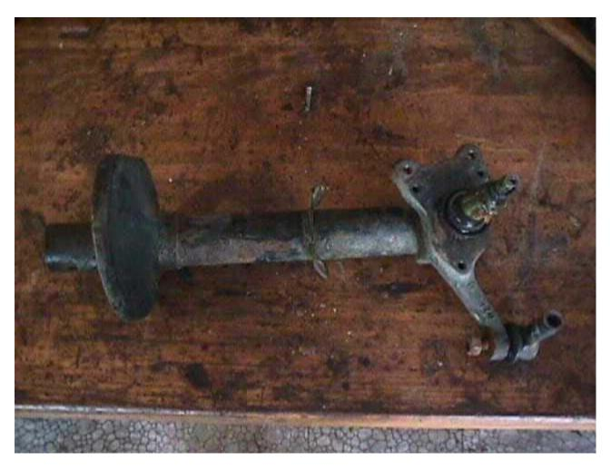
En la fotografía de arriba se puede ver lo que nos ha quedado del tren delantero. Más abajo vemos cómo vamos a cortarlo y soldarlo para fabricar el mecanismo oscilante de la veleta.
