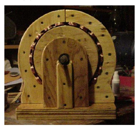
Para fabricar la base armamos todo el conjunto de manera que no hubiera fricción y lo fijamos con pegamento rápido. Esto nos permitió hacerle agujeros en los que irían las cuñas de guía que ya mencionamos. Finalmente colocamos los tornillos de 3". Nada debe vibrar ni moverse en el conjunto terminado.
