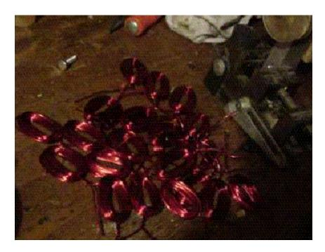
Nuestro alternador es de una sola fase. Si tuviera dos o hasta una tercera sería mucho más potente, pero la distancia desde los imanes hasta las bobinas aumenta con cada capa de bobinas que se coloca. En otro artículo discutimos la colocación de tres fases en un estator., por si se anima a fabricar uno de ese modo.
