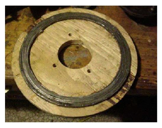
La fotografía que sigue nos muestra el estator colocado en su sitio en la armazón de la rueda delantera. Observe que está fijado de manera que no puede moverse.
