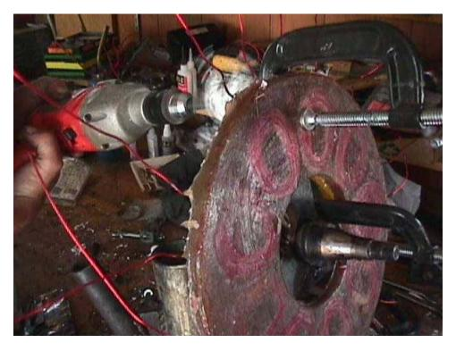
El estator debe quedar alineado centrado exactamente alrededor de la punta de eje. Como el estator tiene 14" de diámetro y cada brazo de soporte del mismo
