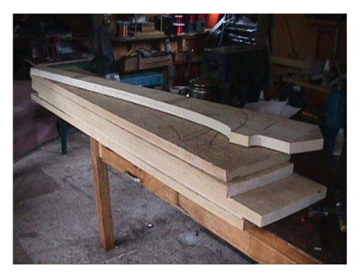
Empezamos con tablas de 5 pies de largo, 7 ½" de ancho y 2" de espesor. Luego dibujamos el contorno de un aspa y lo cortamos. Eso nos da una plantilla del contorno de las tres aspas.
