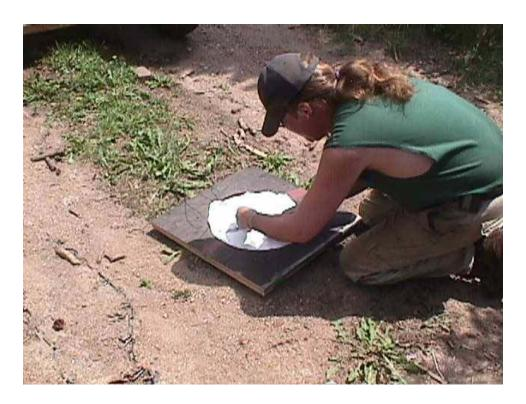
La fibra de vidrio le da resistencia a la resina. Aquí le estamos colocando un anillo de fibra de vidrio de la dimensión del molde a su fondo. Se trata de un anillo de 14" de diámetro con un agujero de 5" en el centro.
