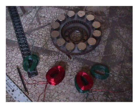
La fotografía anterior muestra el rotor y las bobinas.
