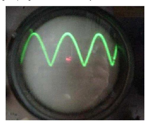
La forma que tiene la curva de la corriente directa tomada del rectificador no es causa de problemas y solo raramente en la recepción de señales de radio y televisión (Se escucha un zumbido). Esto se corrige con un filtro.
