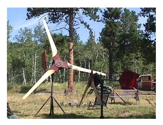
Y aquí está todo listo. Ahora lo que tenemos que hacer es balancear las aspas, hacer el circuito eléctrico y poner funcionar la turbina. Para balancear las aspas la impulsamos a mano y determinamos qué lado pesa más al lado opuesto colocamos pequeños trozos de plomo con unos tornillos. A veces basta con arandelas.
