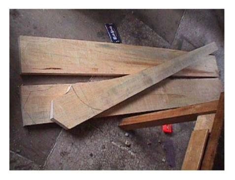
Las aspas están hechas de madera de 20 centímetros de ancho por 37 mm de espesor. Cada una mide 1  $\frac{1}{2}$  metros de largo. Observe que hicimos una plantilla con la primera para cortar las demás.
