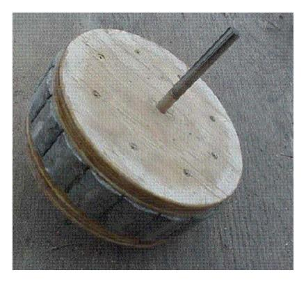
El estator se fabrica sobre un disco de madera de  $\frac{3}{4}$ ". Su círculo interno tiene un radio de 5", lo que deja espacio para las bobinas y el inducido.
