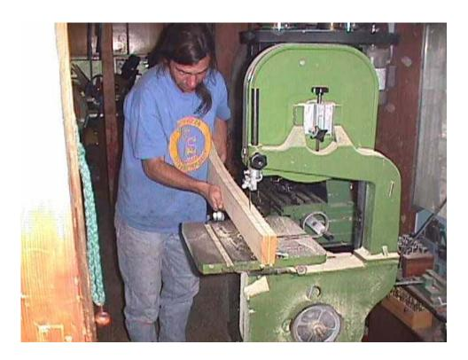
Como se ve en el dibujo anterior, la punta del aspa es de 3/8" de espesor y en el eje es de espesor completo. Hay que quitar bastante material. Una sierra es útil en el primer paso. Deberemos dejar algo de espesor extra para prevenir errores.
