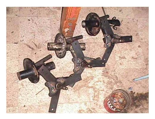
En la fotografía anterior se ven los soportes del estator soldados al chasis de la turbina. Ahora prepararemos el estator para montarlo.
