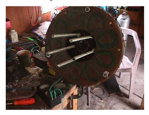
A estas Alturas el estator ha sido cableado y soldado. Se pueden ver los tres terminales de cobre. A nosotros nos gusta recubrir el cableado con resina, o al menos pegarlo al filo del estator para impedir la vibración de los cables. Se puede usar una cubierta con el mismo fin.
