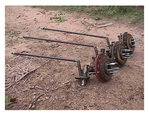
La fotografía anterior nos muestra las tres máquinas casi terminadas. Nos falta pintarlas y colocarles las aspas. Para colocar la veleta le soldaremos pletinas a 1" x 1/8" en sus extremos. El tubo de la vara es de tubo de ¾" y de 5 pies de largo. La veleta es de madera de 3/8" y medirá cinco pies cuadrados (Un poco más de ½ metro cuadrado).
