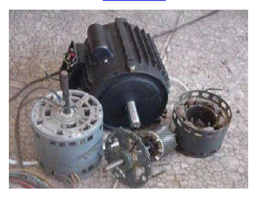
Los motores de inducción se con siguen prácticamente en cualquier parte o acoplados a turbinas, herramientas, etc.. Es posible convertirlos a alternadores sin escobillas de bajas revoluciones instalándoles imanes en sus inducidos. A título de experimento nosotros les hemos instalado imanes sobrantes tomados de los discos duros de computadoras.
