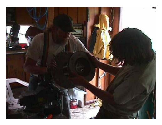
Ahora estamos preparando el segundo rotor. No tiene imanes aún, de manera que se puede manejar con cierta seguridad. Los presentamos a las barras para verificar su alineación, que puede ser algo excéntrica debido a que las barras están apretadas al primer rotor. La idea es determinar si hay error.
