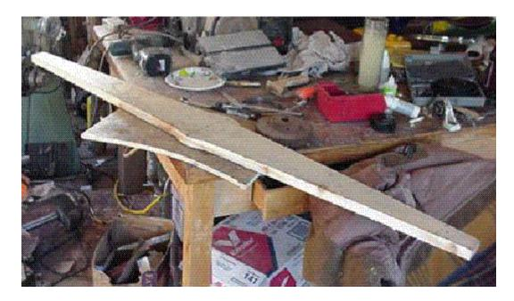
Tienen además un ancho de 2" en sus puntas y 4" en el núcleo, que se ensancha en el centro hasta llegar a 6". La caída en el núcleo serán tanta como un trozo de madera de 1" x 4" permitirá.
