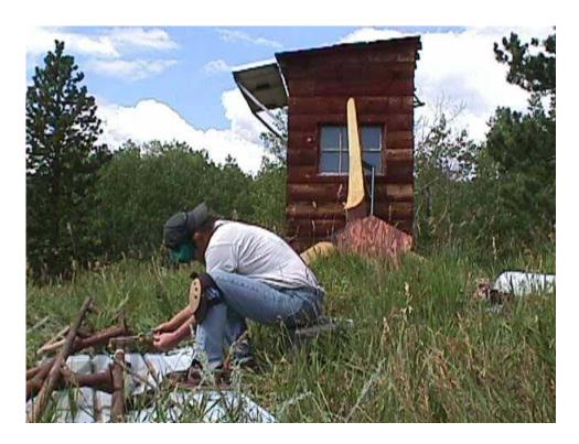
Para fabricar la torre estamos usando los restos de una escalera. Uno de sus tubos es de 2" soldado a otro tubo de 1 ½". Una de las secciones nos servirá de base de la torre y la otra nos servirá de brazo de izamiento. En la fotografía estamos cortando lo que necesitamos para soldarlo posteriormente a su forma final.
