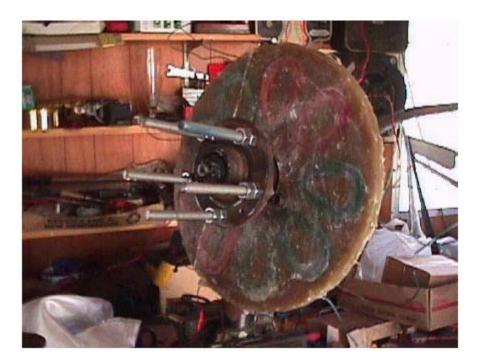
En esta fotografía el estator está montado a la máquina. También hemos montado el soporte de la rueda. Los pernos ahora son más largos y de barra roscada. Los pernos originales se retiran fácilmente con un martillo. La barra se fija con tuerca y contratuerca. Con otra tuerca se ajusta la distancia a que queremos que nos quede el rotor del estator. (Aproximadamente 1/8 de pulgada.
