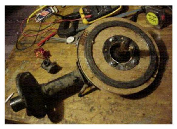
Hemos dejado la placa trasera del conjunto para proveer protección adicional a nuestro estator, pero le adelantamos que la puede eliminar. Los tornillos que empleamos para fijar el estator son los que vienen con la unión articulada en el vehículo. Si consigue su unidad completa, no bote esos tornillos.
