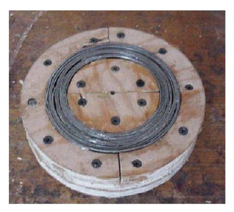
Necesitamos 12 bobinas que se fijan encima de las laminillas en un arco de 30 grados cada una.
