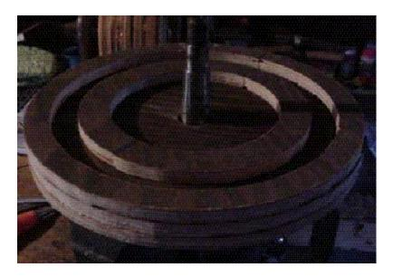
Esta láminas amplían el campo magnético de los imanes y su aislamiento evita la difusión de corrientes parasíticas entre ellas. No use metal magnetizable (De alto contenido de carbono) en sus láminas. Su magnetización ocasiona un fenómeno llamado histéresis por el que se desarrollan fuerzas para compensar la acción de los imanes. (Corrientes de bajo voltaje y alto amperaje que se presentan en núcleos de estatores de acero sólido). Use resina epóxica (En bastante cantidad) para fijarlas.
