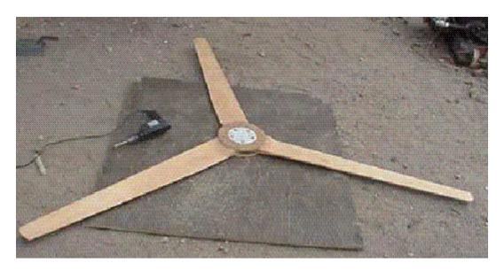
Es de tres aspas y de 96" de diámetro. La caída en la punta es de aproximadamente 4 grados. En el eje aproximadamente 8. En el eje cada aspa es de 7" de ancho y en la punta de  $3\frac{1}{2}$ ". Además tienen un espesor de 7/8" en el eje y de 5/8 en la punta. En su lugar más ancho el espesor es aproximadamente 35% de la longitud del plano.
